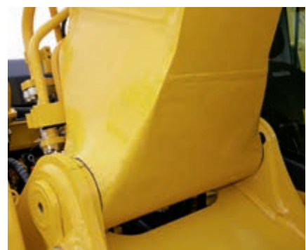
Gegossener Auslegerfuß und einteilige Platten am Ausleger
